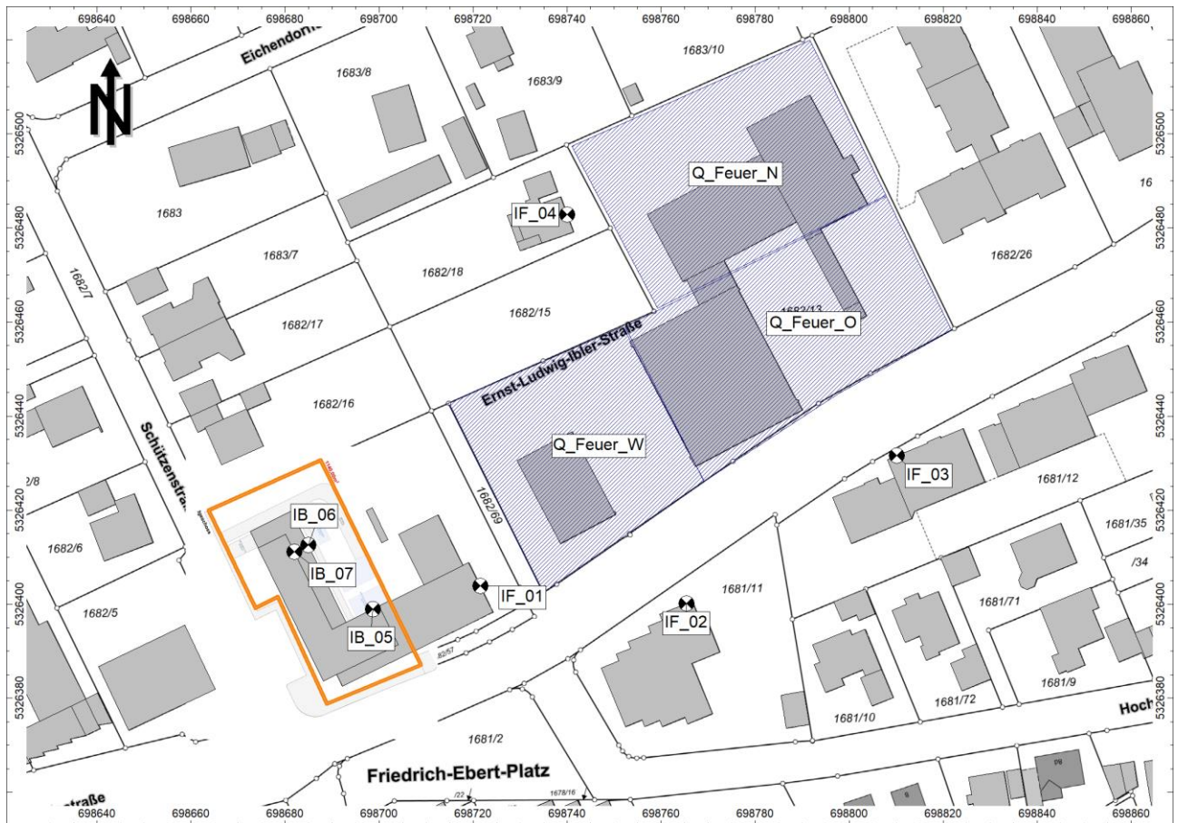
Abbildung 9: Lageplan mit Darstellung der auf dem Flurstück 1682/13 berücksichtigten Flächenschallquellen und benachbarten Immissionsorte (Darstellung ist genordet)
